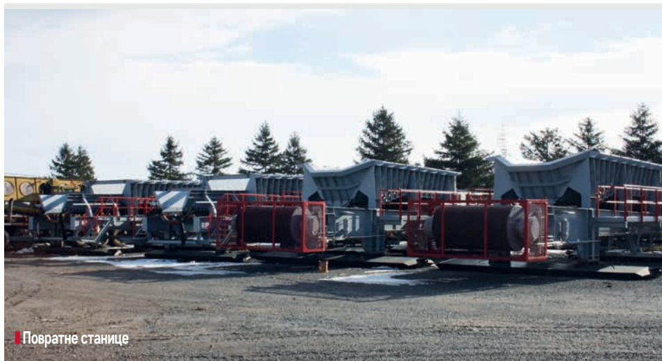
Завршне провере транспортера на монтажном плацу
